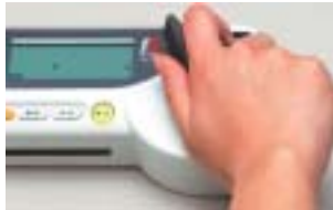
測定部に試料を入れ、一気に粉碎します。
