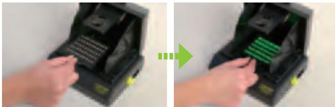
試料トレイを載せると、自動的にLEDが点灯します。
